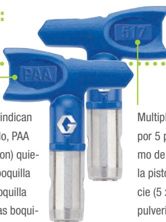
Multiplique el primer dígito (5) por 5 para obtener el ancho mínimo de pulverización al mantener la pistola a 30 cm de la superficie ( $5 \times 5 = 25$  cm de ancho de pulverización). Los dos últimos dígitos (17) corresponden a la apertura, que en este caso es de 0,017 pulgadas.
